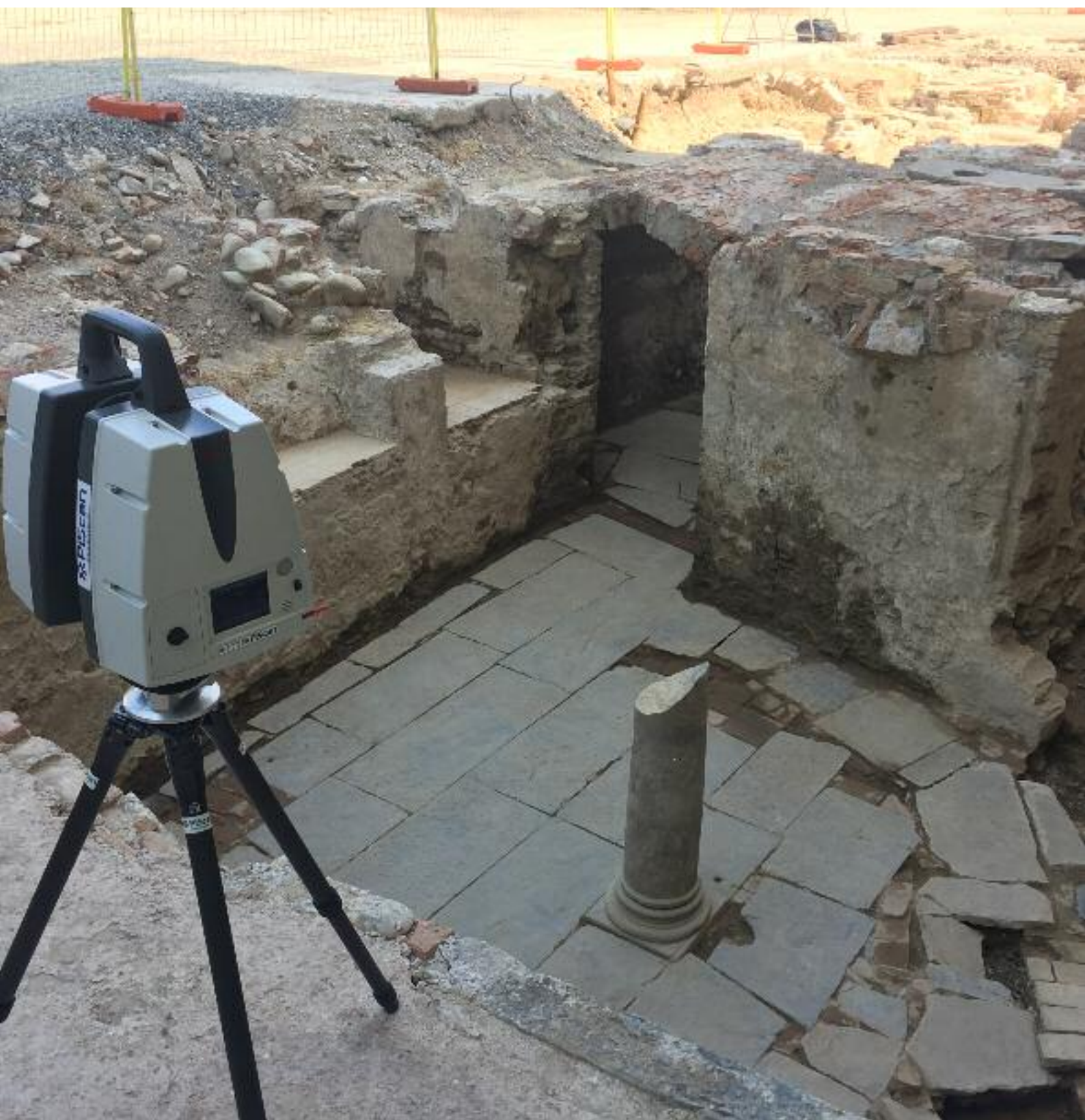
Fig. 2. Il laser scanner in funzione durante il rilievo.
