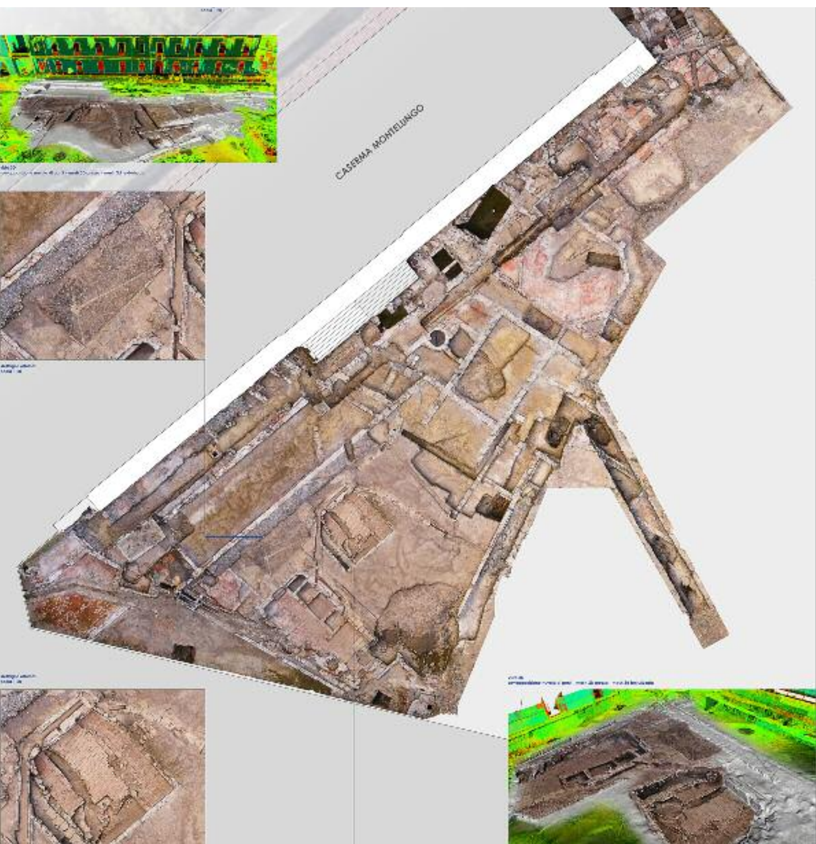
Fig. 1. Collage fotografico che rappresenta una porzione del rilievo della Montelungo, con i diversi step grafici che conducono alla realizzazione finale del prodotto 3D.
